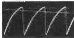
ten Schwingungen eingestellt werden können. Widerstand  $R_3$  beeinflusst die Amplituden der Schwingungen.
